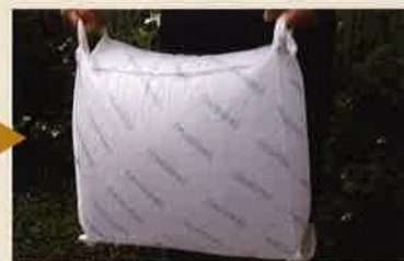
約2分後に約20kgの土嚢が完成
